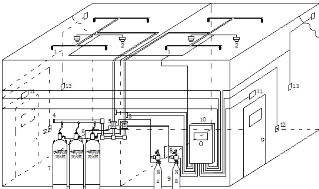
图 2 组合分配系统示意图
